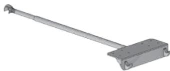
**HOAC®Heberoller** | Verwandelt die feststehende Tribüne in eine verfahrbare. Diagonalriegel mit einseitiger Rollenplattform, der, in entsprechenden Positionen in den Vertikalrahmen unten eingehängt, die Tribüne/Bühne zum manuellen Verfahren anhebt.
